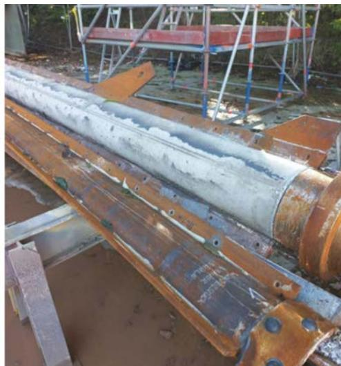
**Bild 10** Betonverfüllung der Pendelstützen – geöffnete Arbeitsprobe
