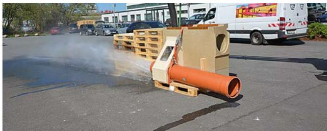
**Bild 7** Spülversuch und Kamerabefahrung des Dreikammer-Tauchwandschachts der Firma ACO GmbH
